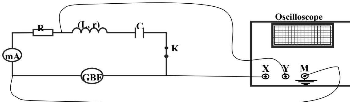
4-a  $\forall N$ , on a  $Z > R \Rightarrow Z I_m > R I_m \Rightarrow U_m > U_{Rm} \Rightarrow$  la courbe qui a l'amplitude la plus grande correspond à  $u(t) \Rightarrow (C_1)$  correspond à  $u(t)$  (même sensibilité verticale).
