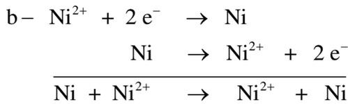
c- Electrolyse à anode soluble.
